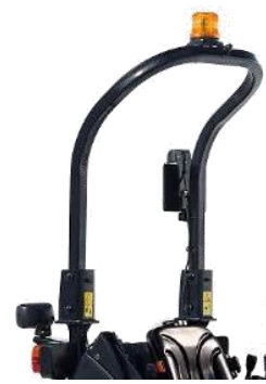
Конструкция защиты от переворачивания сзади
