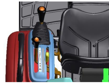
Переключатель передач, переключатель диапазонов и рычаг BOM
