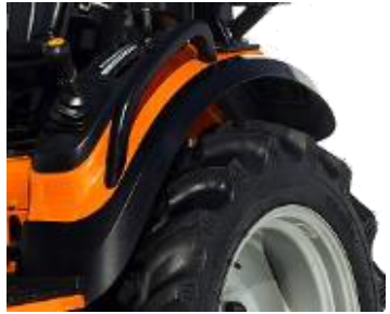
Плавные изогнутые крылья – защищают посеы от повреждений
